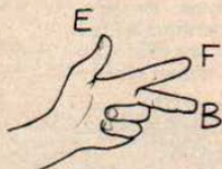
Fig. 16 — La règle des trois doigts
